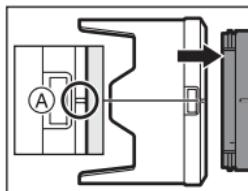
**2 Drehen Sie die Gegenlichtblende in Pfeilrichtung, bis die Markierung B (○) an der Gegenlichtblende an der Markierung am Objektivrand ausgerichtet ist.**
