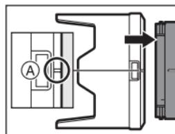
**2 Faites tourner le parasoleil dans le sens de la flèche pour aligner le repère B (○) présent sur le parasoleil sur le repère situé à l'extrémité de l'objectif.**
