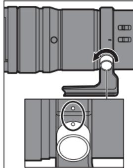
**2 Haga coincidir las marcas de la montura del trípode y la perilla de bloqueo de la montura del trípode.**
