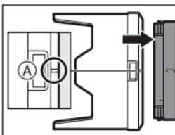
**2 朝箭頭指示的方向轉動鏡頭遮光罩，將鏡頭遮光罩上的標記(B)(○)對準鏡頭頂端的標記。**
