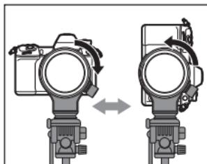
**3 Gire la perilla de bloqueo de la montura del trípode en la dirección de la flecha para ajustarla firmemente.**
