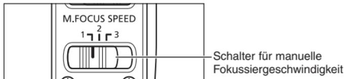
Legen Sie die Geschwindigkeit für den manuellen Fokus mit dem Schalter für manuelle Fokussiergeschwindigkeit fest.
